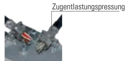
Das Kabel wird mit der Zugentlastungspressung am Kabelhalter fixiert. Die Kabelhalter sind lieferbar mit Durchmessern von 6 bis 12 mm, dies ermöglicht den Anschluss beliebiger Kabeldurchmesser von 6 bis 12 mm, wobei nötigenfalls der Kabeldurchmesser mittels Schrumpfschlauch an die Kabelhalter angepasst werden können. Bei solchen Anpassungen ist eine Überprüfung der Zugentlastungspressung mittels Zugversuch zweckmässig. Dabei ist eine Auszugskraft von mindestens 150 N während 1 Minute empfohlen.
