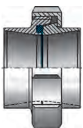
S-ISO-Rohrverschraubung 2103 mit Perbunandichtung
