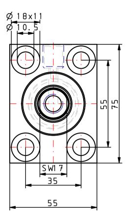
Max. Betriebsdruck / max. operating pressure 500 bar!
