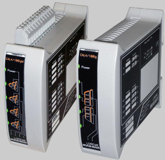
Série d'isolateurs galvaniques composé de plusieurs cellules indépendantes et autonomes conçus pour le traitement des boucles de courant 0..4..20 mA . Chaque entrée peut être active ou passive, permettant de mesurer un courant issu d'un transmetteur actif ou d'alimenter un convertisseur en technique 2 fils et de mesurer le courant de la boucle.
