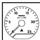
Der analoge Drehzahlmesser zeigt, durch das Masterinstrument angesteuert, die aktuelle Drehzahl an.
