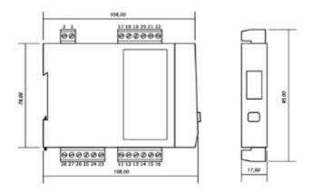
Dimensions: Largeur: 17,5 mm - Hauteur: 76 mm - Profondeur: 106 mm
